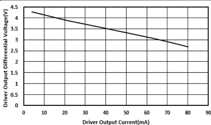
图 7-2. 驱动器差分输出电压与驱动器输出电流
